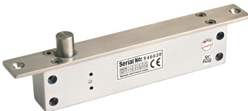
Электромеханический соленоидный замок ST-DB520MT предназначен для работы в составе систем контроля доступа с электронным управлением блокировкой дверей. Замок ST-DB520MT является нормально-закрытым, т.е. разблокируется при подаче питания и блокируется при его отключении. Для мониторинга положения створки двери в системе контроля доступа можно использовать соответствующий выход замка.
