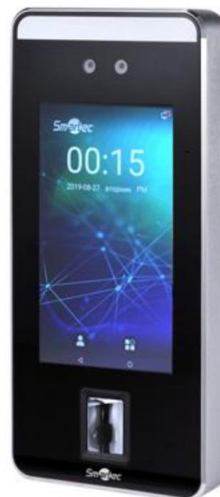
Биометрический считыватель ST-FR042 предназначен для идентификации по геометрии лица и/или по отпечатку пальца и используется в системах контроля доступа и учета рабочего времени. Устройство поддерживает следующие режимы идентификации: по геометрии лица, по отпечатку пальца, по коду – отдельно или в различных логических комбинациях.
