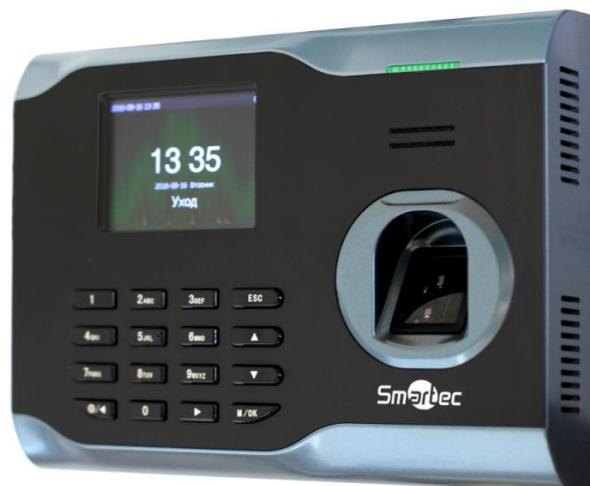
Терминал учета рабочего времени ST-FT161EM с идентификацией по отпечаткам пальцев и/или по проксимити картам предназначен для работы в составе системы учета рабочего времени на базе программного обеспечения «Таймекс», которое выполняет сбор данных о приходе/уходе персонала с работы. ST-FT161EM рассчитан на 3000 шаблонов, т.е. если на каждого человека заводится по 2 шаблона, то общее количество пользователей составит 1500.
