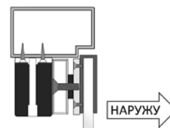
Установка с использованием U адаптера
