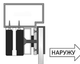
Установка с использованием U адаптера
