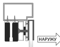
Установка с использованием U адаптера
