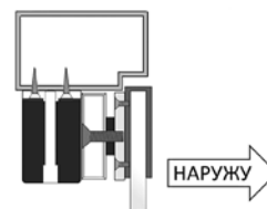
Установка с использованием U адаптера
