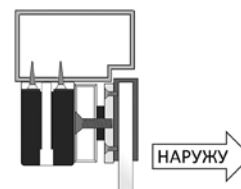
Установка с использованием U адаптера
