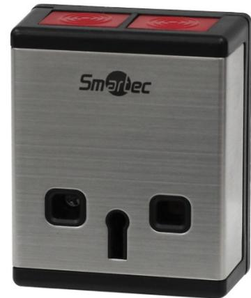
Извещатель ручной с фиксацией ST-AB015 предназначен для активации сигнала тревоги нажатием одновременно двух кнопок для предотвращения ложных срабатываний.
