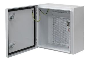
Бокс металлический универсальный ST-AC010ML-WT с классом защиты IP66 предназначен для монтажа какого-либо оборудования на DIN-рейку. Кроме того, возможен монтаж электронных плат на перфорированную панель с помощью идущих в комплекте пластиковых стоек. Бокс комплектуется муфтами для ввода кабеля и креплением на столб. Бокс может дополняться опциональными обогревателем ST-AC030HD с термостатом ST-AC001TD для расширения температуры эксплуатации от -40 °C.
