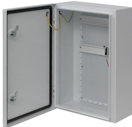
Бокс металлический универсальный ST-AC010MX-WT с классом защиты IP66 предназначен для монтажа какого-либо оборудования на DIN-рейку. Кроме того, возможен монтаж электронных плат на перфорированную панель с помощью идущих в комплекте пластиковых стоек. Бокс комплектуется муфтами для ввода кабеля и креплением на столб. Бокс может дополняться опциональными обогревателем ST-AC030HD с термостатом ST-AC001TD для расширения температуры эксплуатации от -40 °C.
