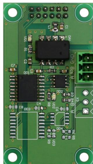
Модуль ST-AC485 предназначен для расширения функционала контроллера ST-NC441 за счет добавления порта последовательного интерфейса RS-485. Порт RS-485 обеспечивает подключение к контроллеру дополнительных модулей ST-NB441D для увеличения количества дверей, входов и выходов.
