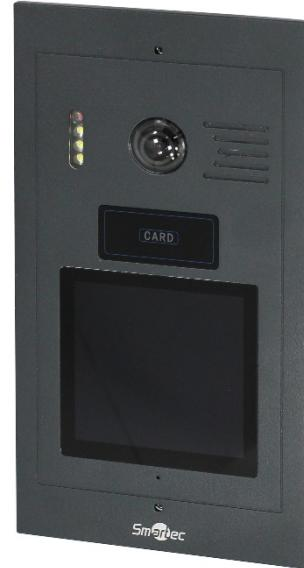
Панель вызова видеодомофонной связи ST-DP525DTS-GR используется для реализации односторонней видеосвязи и двухсторонней аудиосвязи с мониторами по IP линии. Панель вызова оснащена FHD камерой и ИК подсветкой, автоматически активирующейся при снижении освещенности. Антивандальный корпус из алюминиевого сплава имеет высокий уровень погодозащищенности, а объектив видеокамеры защищен ударопрочным стеклом. ST-DP525DTS-GR совместима с любыми IP мониторами видеодомофонной связи Smartec.
