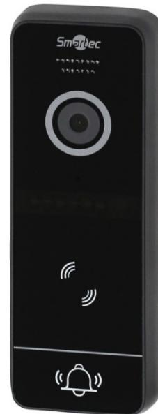
Панель вызова видеодомофонной связи ST-DS506CMF-BK используется для реализации односторонней видеосвязи и двухсторонней аудиосвязи с мониторами по 4-х проводной линии. Дополнительно панель вызова имеет встроенный автономный контроллер управления доступом со считывателем карт формата MIFARE. Память устройства рассчитана на 200 пользователей с идентификацией по карте.
