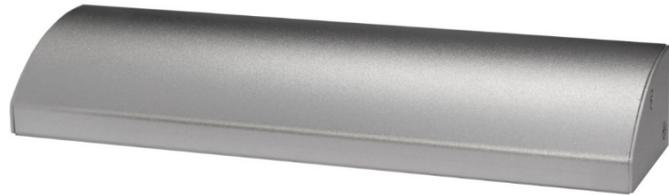
Кронштейн LC типа с крышкой выполнен из алюминия и предназначен для крепления электромагнитных замков на двери, открывающиеся наружу, когда ширина дверной коробки не допускает непосредственный монтаж замка.
