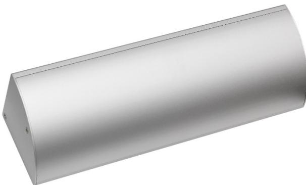
Кронштейн LC типа выполнен из алюминия и предназначен для крепления электромагнитных замков на открывающиеся наружу двери, когда глубина дверной коробки не допускает непосредственный монтаж замка. Кронштейн имеет возможность регулировки выноса замка от двери. Крышка кронштейна позволяет скрыть монтажные элементы замка и проводку, что придает входной группе более эстетичный вид и защищает проводку от преднамеренного повреждения.
