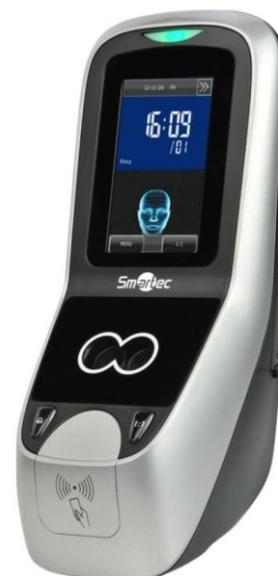
Биометрический считыватель ST-FR040EM предназначен для идентификации по геометрии лица и/или по проксимити картам стандарта EM и используется в системах контроля доступа и учета рабочего времени. Устройство поддерживает такие режимы распознавания пользователей, как идентификация по лицу, по карте, по коду или их любые логические комбинации.
