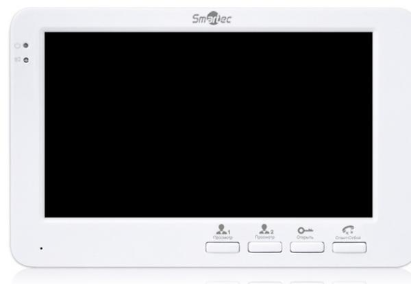
Монитор видеодомофонной связи ST-MS107-WT используется для реализации односторонней видеосвязи и двухсторонней аудиосвязи с панелями вызова по 4-х проводной линии. Этот монитор является простейшим устройством и поддерживает только базовый функционал. ST-MS107-WT совместим со всеми панелями вызова Smartec стандарта CVBS, а также со сторонними панелями вызова при использовании устройств сопряжения.
