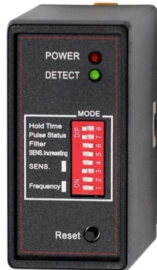
Индукционный одноканальный датчик ST-RB001LD предназначенный для обнаружения транспортных средств для обеспечения безопасности или автоматизации проезда. При обнаружении транспортного средства, проезжающего над индукционной петлей, контроллер датчика включает выходное реле.
