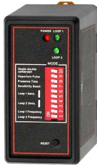
Индукционный двухканальный датчик ST-RB002LD предназначен для обнаружения транспортных средств с целью обеспечения безопасности или автоматизации проезда. При обнаружении транспортного средства, проезжающего над индукционной петлей, контроллер датчика включает выходное реле.
