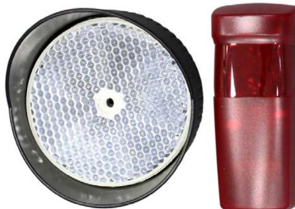
Фотозлемент ST-RB003PD предназначен для обнаружения пересечения инфракрасного луча автотранспортом или человеком. Он применяется в качестве устройства безопасности в составе системы контроля автомобильного проезда под управлением шлагбаума или как инициирующее устройство автоматизации проезда. Использование пассивного отражателя позволяет упростить установку системы контроля проезда, а также дальнейшее ее обслуживание, за счет отказа от прокладки кабельных трасс в дорожном полотне.
