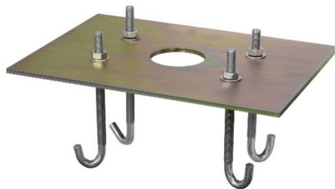
Монтажное основание ST-RB200MP предназначено для монтажа тумбы шлагбаумов 200 и 300 серий (ST-RB2\*\*\*\* и ST-RB3\*\*\*\*) и устанавливается на этапе подготовки фундамента. Монтажное основание не является обязательным узлом для установки тумбы шлагбаума, но обеспечивает удобство и надежность монтажа.
