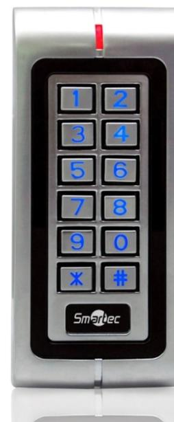
Автономный вандалозащищенный контроллер ST-SC040EK со встроенным считывателем проксимити карт EM и клавиатурой предназначен для построения автономной системы контроля доступа с управлением одной дверью. Поддерживаются режимы идентификации: карта или код, карта плюс код, только карта. Наличие клавиатуры обеспечивает возможность удаления пользователей и отдельных карт, например, при их утере, т.е. без наличия самих карт.
