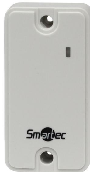
Автономный контроллер ST-SC111 предназначен для построения независимой системы контроля доступа с управлением одной дверью. Этот контроллер оснащается интерфейсами Wiegand и iButton и используется совместно с внешним считывателем. При этом считыватель устанавливается снаружи, а контроллер – внутри защищаемого помещения, за счет чего обеспечивается более высокий уровень безопасности.
