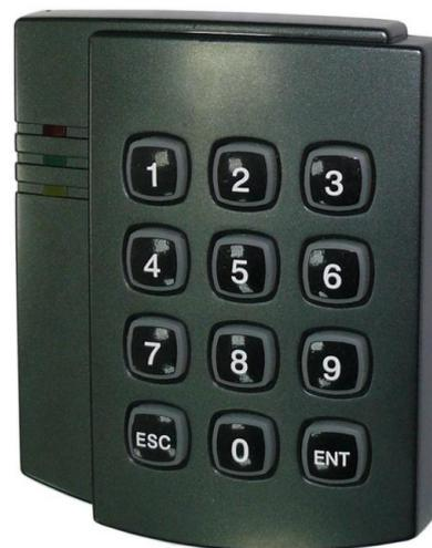
Автономный контроллер ST-SC130EK с встроенным считывателем проксимити карт EM и клавиатурой предназначен для построения автономной системы контроля доступа с управлением одной точкой доступа.
