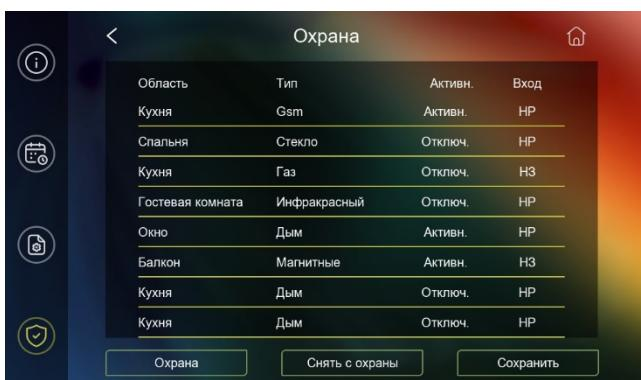
После завершения настройки всех областей, изменения необходимо сохранить, нажав на соответствующую кнопку и потом нажать на кнопку «Охрана», для постановки активных зон на охрану. Автоматически запускается 60 секундный таймер обратного отсчета постановки на охрану.
