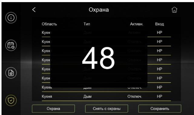
При сработке любого из датчиков звучит сигнал тревоги и открывается окно со списком всех датчиков. Стока сработавшего датчика подсвечивается красным цветом.
