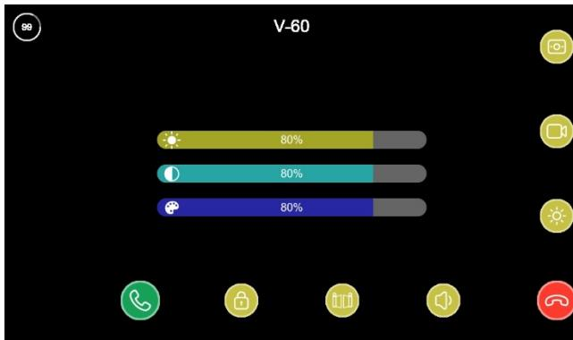
Нажмите на иконку микрофон для включения/выключения двусторонней аудиосвязи между монитором и вызывной панелью.(Примечание: во время приема звонка двустороннюю аудиосвязь отключить нельзя)
