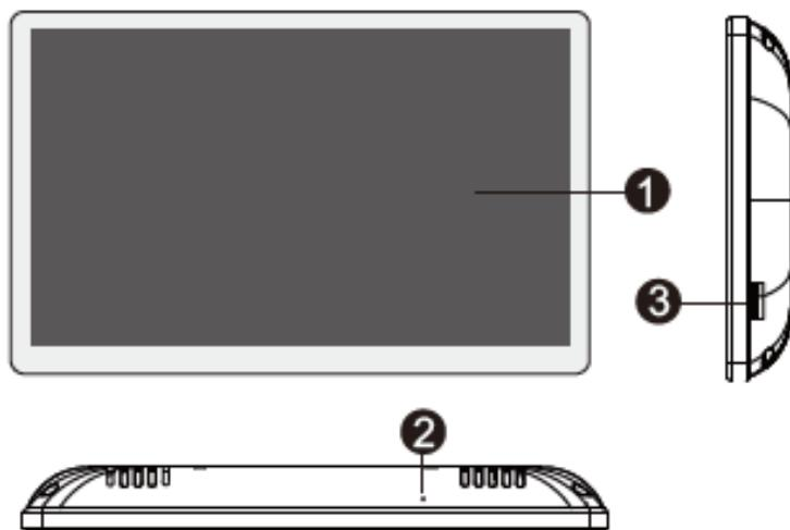
1 – экран монитора используется для трансляции видеоизображения с панели вызова.
