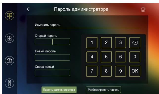
В следующем пункте «Высшие настройки» вы можете отвязать монитор от приложения «SmartLife», выполнить перезагрузку, сбросить монитор до заводских настроек и произвести обновление программного обеспечения. Для обновления ПО необходимо вставить в монитор SD карту с новой прошивкой. Файл «image.dd» должен находиться в корневом каталоге карты.
