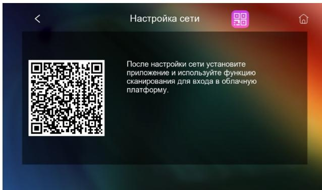
Нажмите на значок QR-кода на мониторе, наведите телефон на QR-код на мониторе, и когда код будет успешно отсканирован, устройство отобразится. Выберите «Добавить устройство». Дождитесь окончания установки. Добавленное устройство отобразится на домашней странице приложения.
