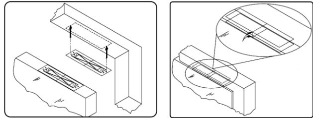
Шаг 3. Просверлите отверстия согласно шаблону и сделайте отверстие для индикатора.
