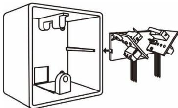
Поверните ключи против часовой стрелки на 45° и извлеките блок с цилиндром.
