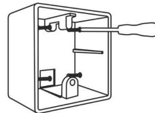
Установите и закрепите переднюю панель с уплотнителем.
