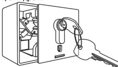
Установите блок с цилиндром, предварительно повернув ключ на 45°.
