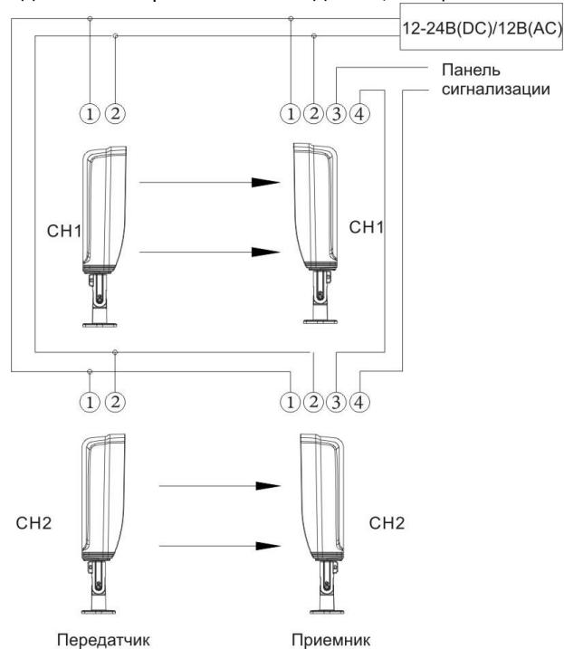
Подключение нескольких детекторов для увеличения длины перекрываемой зоны, параллельное подключение линии питания, последовательное подключение тревожных выходов НЗ, ОБЩ.
