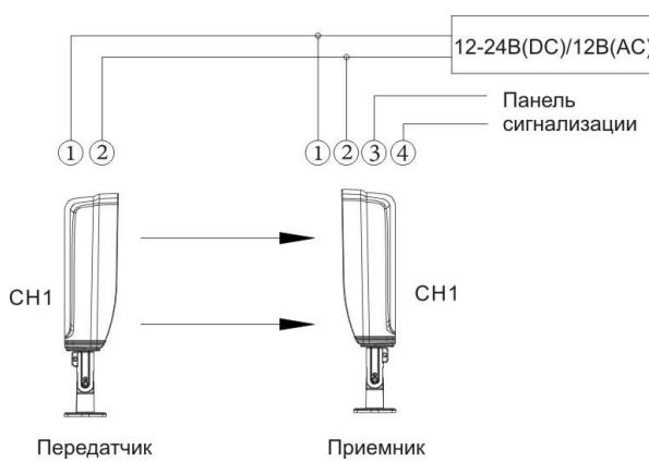
**Подключение нескольких детекторов для увеличения высоты перекрываемой зоны, параллельное подключение линии питания, последовательное подключение тревожных выходов НЗ, ОБЩ.**
