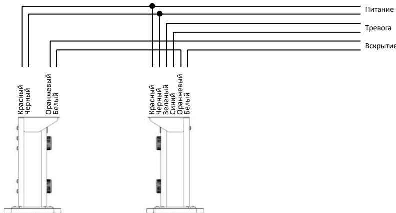
**Подключение нескольких детекторов для увеличения размеров перекрываемой зоны**, параллельное подключение линии питания, последовательное подключение тревожных выходов НЗ, ОБЩ и последовательное подключение выходов датчиков вскрытия.
